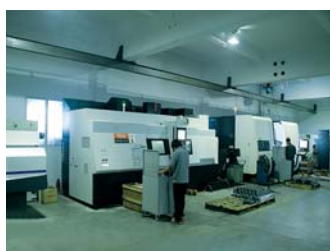
德国 / 日本进口双主轴车铣复合加工中心 Double-spindle turning & milling & boring machining center imported from Germany and Japan
